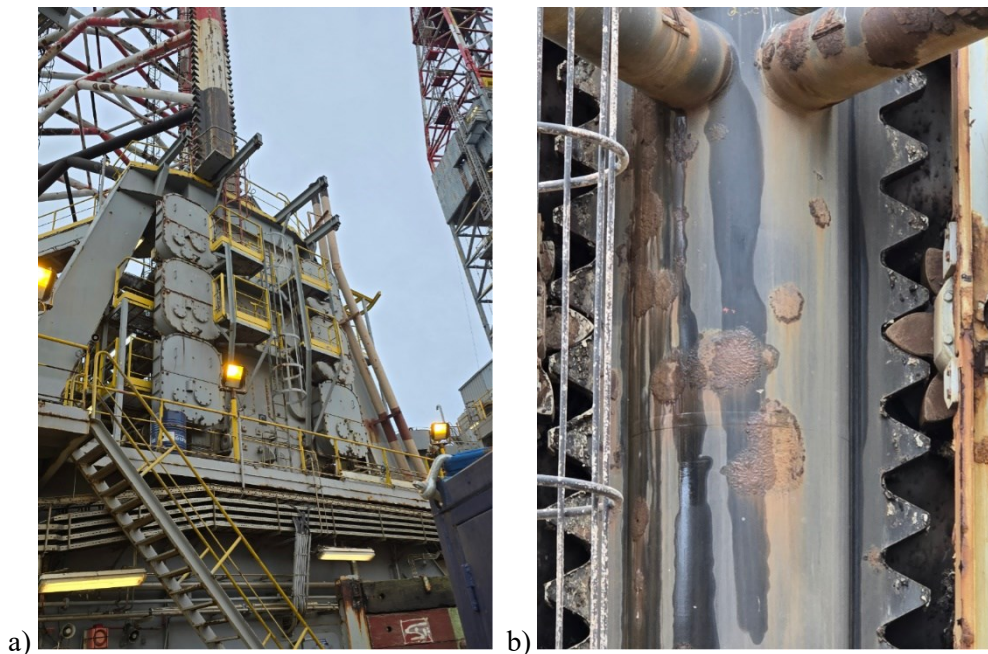
Rys. 1. Jeden ze słupów nogi platformy: a) przekładnie, b) zbliżenie listwy zębatej ( rack ) i koła zębatego ( pinion ) – systemu podnoszenia platformy
