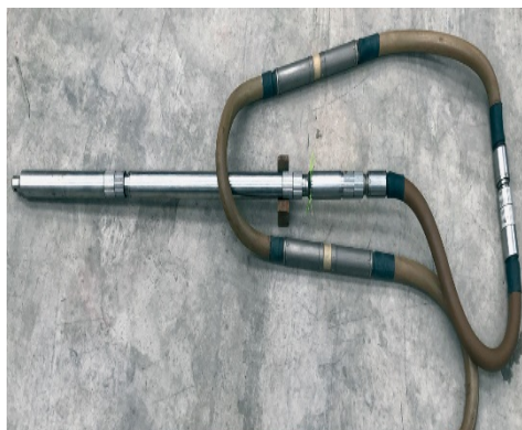
Rys. 3. Urządzenie służące do profilowania otworowego
