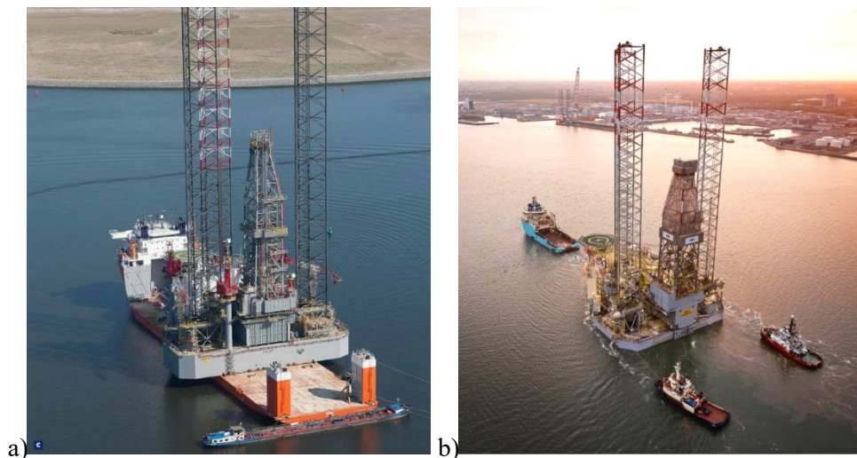
Rys. 3. a) Holowanie platformy: a) „suche” – na statku heavy lift , b) „mokre” – zestaw holowniczy
