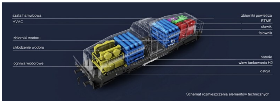
Rys 6. Schemat rozmieszczenia elementów technicznych w lokomotywie SM42-6Dn
