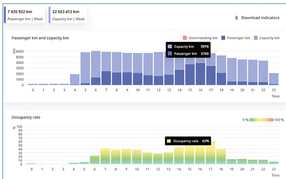
Rysunek 80. PTV Lines – widok przedstawiający liczbę pasażero- i miejscokilometrów oraz stopień wykorzystania miejsc w pojazdach
