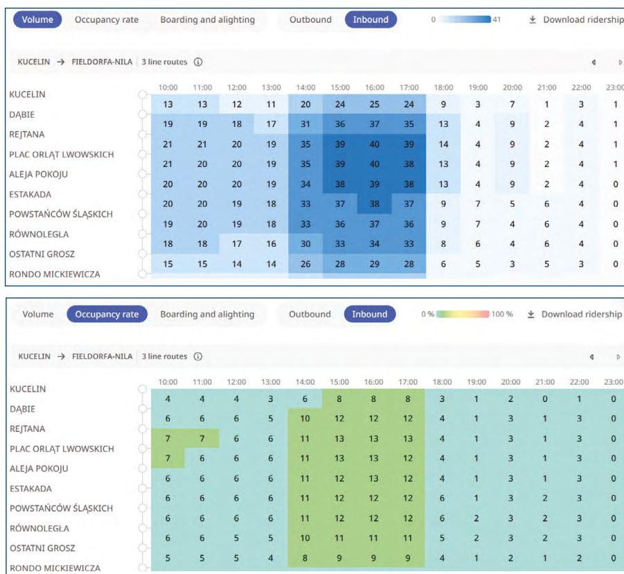
Rysunek 84. PTV Lines – widok przedstawiający liczbę pasażerów na odcinkach międzypunktowych oraz procent wykorzystania miejsc w pojazdach
