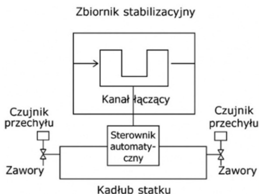
Rys. 4.10. Schemat poglądowy systemu Flume z oznaczeniem przepływu cieczy i elementów sterowania
