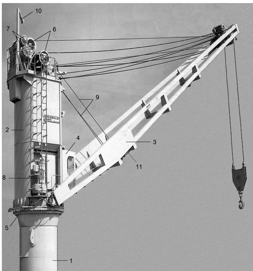
Rys. 3.17. Widok dźwigu o napędzie elektrycznym firmy BLM (1 – kolumna, 2 – ostojnica, 3 – wysięgnik, 4 – kabina operatora, 5 – podstawa, 6 – bębny linowe mechanizmów podnoszenia/ opuszczania i zmiany wysięgu, 7 – silniki elektryczne mechanizmów podnoszenia/ opuszczania i zmiany wysięgu, 8 – silnik elektryczny mechanizmu obrotu dźwigu, 9 – liny układu kompensacyjnego, 10 – dźwig pomocniczy, 11 – reflektory sodowe)
