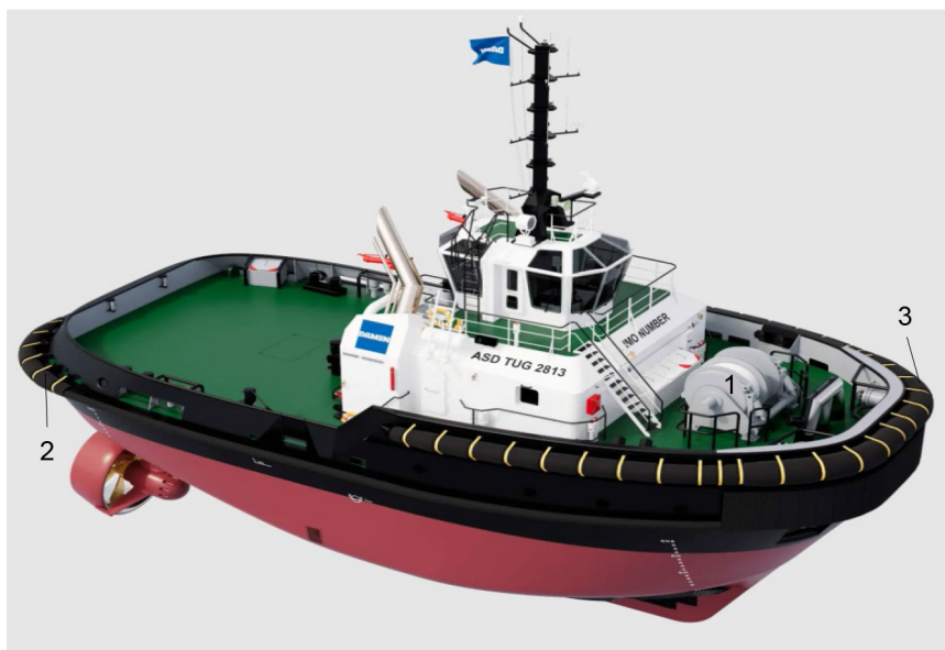
Rys. 1.27. Widok typowego holownika portowego (1 – wciągarka holownicza, 2 – odbijacz rufowy, 3 – odbijacz dziobowy)
