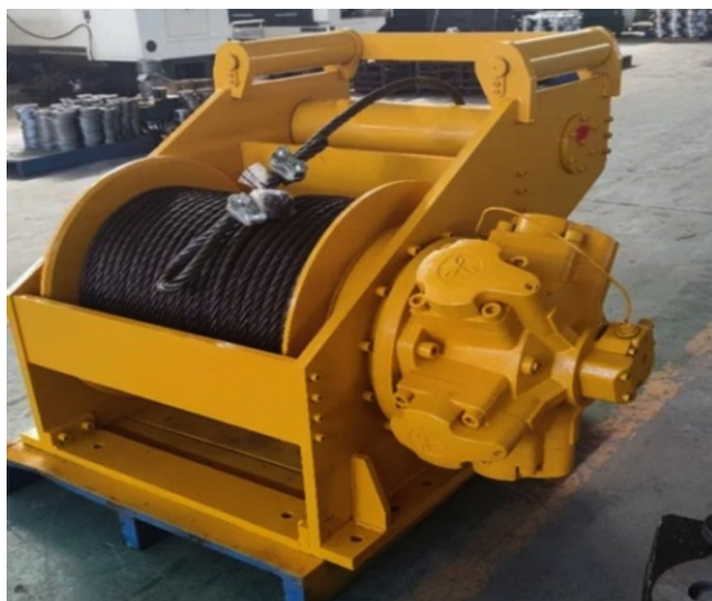
Rys. 5.2. Widok windy z napędem hydraulicznym
