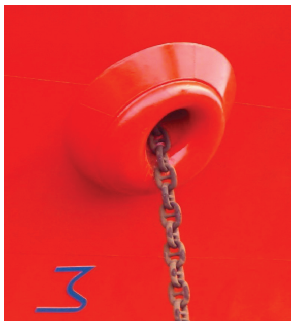
Rys. 1.6. Widok kluzy kotwicznej od strony poszycia burtowego i fragmentu łańcucha kotwicznego
