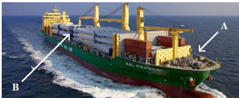
Rys. 4. Statek specjalistyczny do przewozu ładunków wielkogabarytowych dla morskich farm wiatrowych (ang. project cargo ship ): A – specjalistyczna jednostka pływająca (ang. project cargo ship ), B – części turbin wiatrowych
