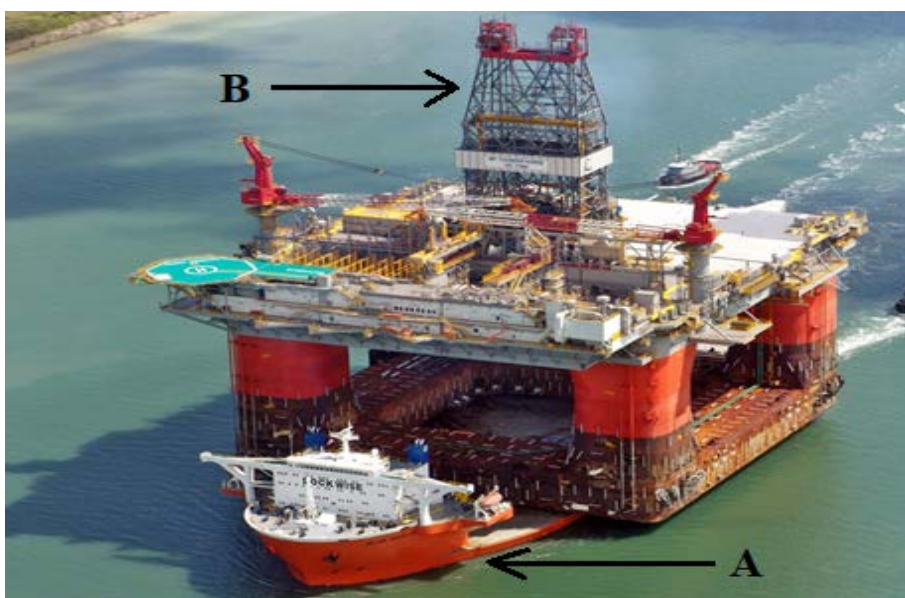
Rys. 2. Statek typu półzanurzalnego (ang. semi-submersible ): A – jednostka półzanurzalna, B – platforma wiertnicza
