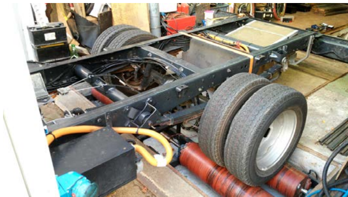
Rys. 3. Widok rzeczywistej hamowni podwoziowej dla pojazdów z napędem elektrycznym
