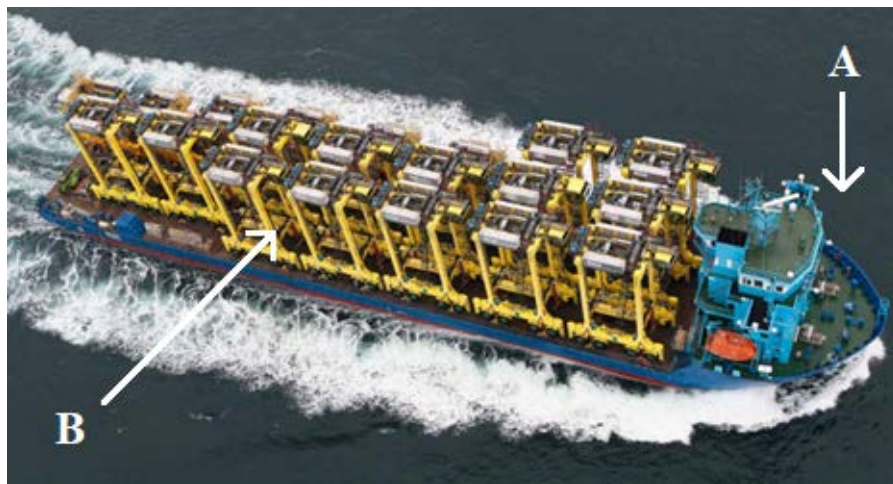
Rys. 5. Statek z otwartym pokładem głównym (ang. open deck cargo ): A – specjalistyczna jednostka pływająca (ang. open deck cargo vessel ), B – wozy bramowe (podsiębierne)
